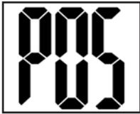
Anschließend fährt der Antrieb in die Montageposition (**POS**). Die Anzeige blinkt, sobald die Montageposition erreicht ist.
